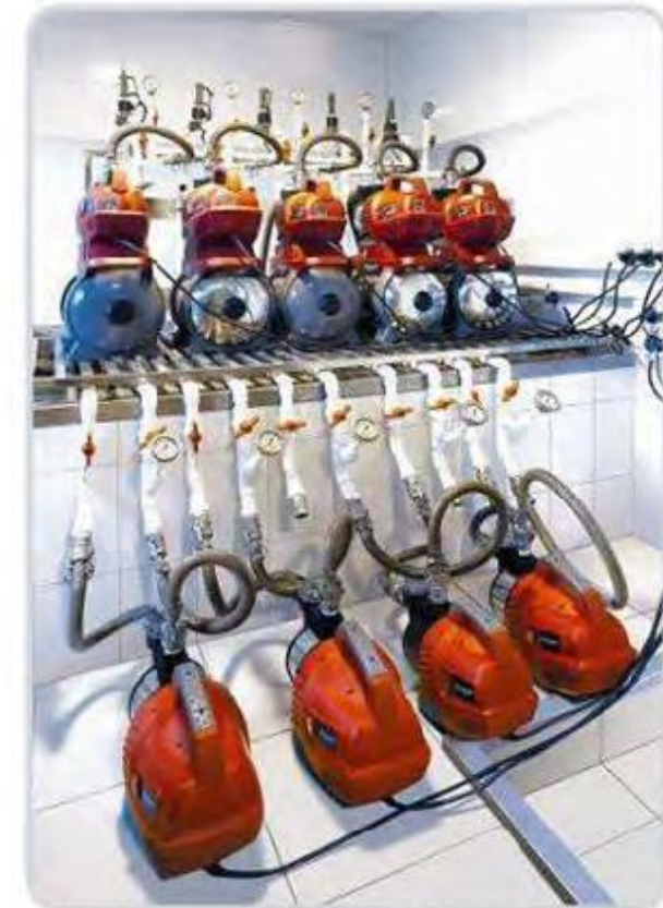
▲ Garterpumpen / Hauswasserwerke - Dauerlauf Prüfung
